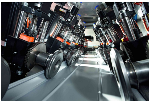
Bild 1: Profiliervorgang am Beispiel eines Falzprofils
